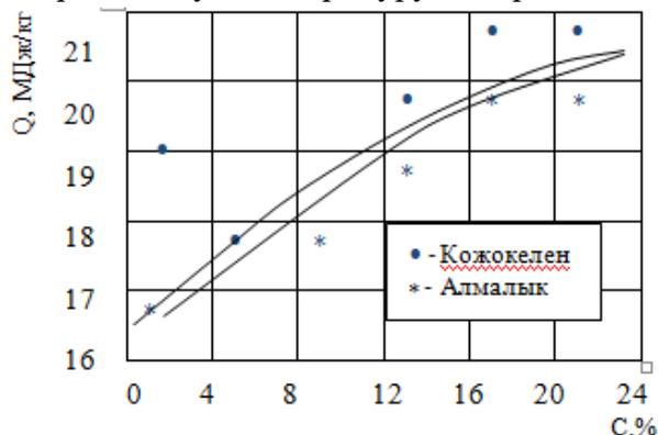
Рис. 7. Зависимость теплотворности брикетов от концентрации тростника.
