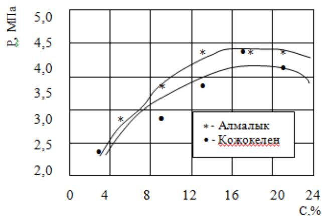
Рис. 6. Зависимость прочности брикетов от концентрации тростника.
