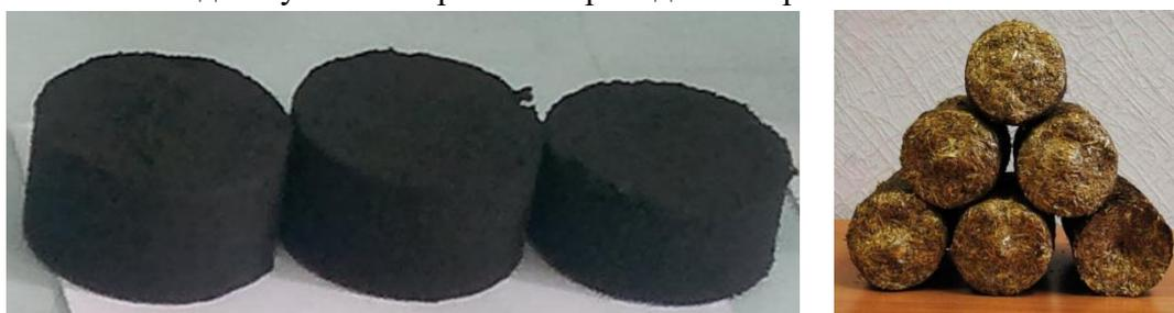
Рис.4. Брикеты, полученные измельченным тростником с угольной мелочью и без них.
