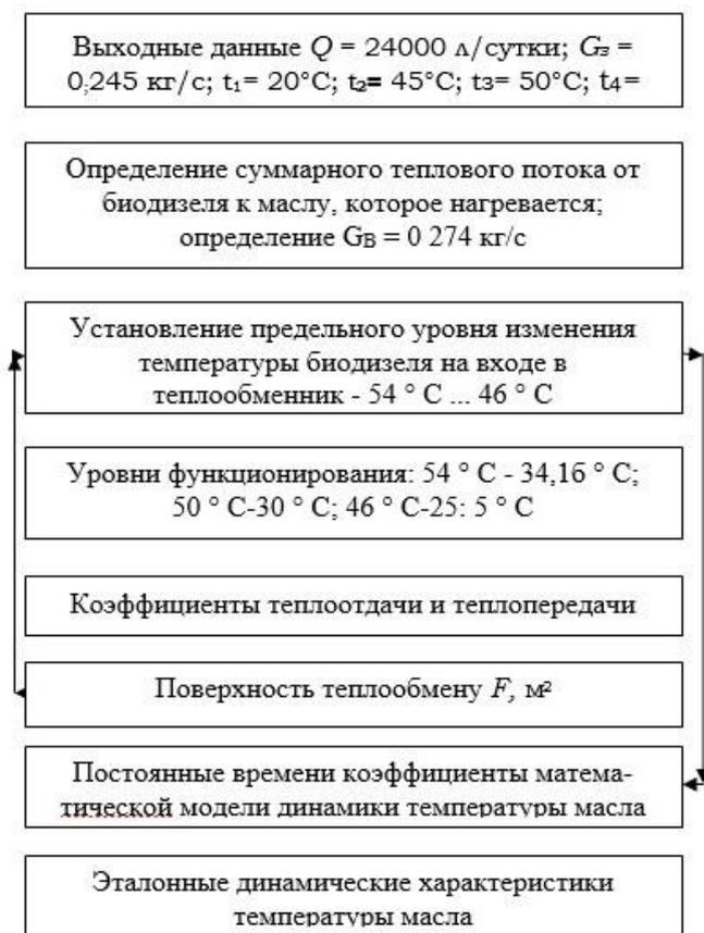
**Рисунок 1** - Информационная схема математического моделирования динамики биодизельной установки и теплообменника подогрева масла биодизелем  $Q$  - производительность биодизельной установки, л/сутки  $G_z$ ,  $G_b$  - расход биодизеля, масла, кг/с;  $t_1$ ,  $t_2$  - температура масла на входе в теплообменник и на выходе из теплообменника, К, соответственно;  $t_3$ ,  $t_4$  - температура биодизеля на входе в теплообменник и на выходе из теплообменника, К
