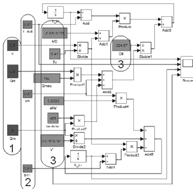
Рисунок 2 – Математическая модель теплицы в среде Matlab-Simulink
