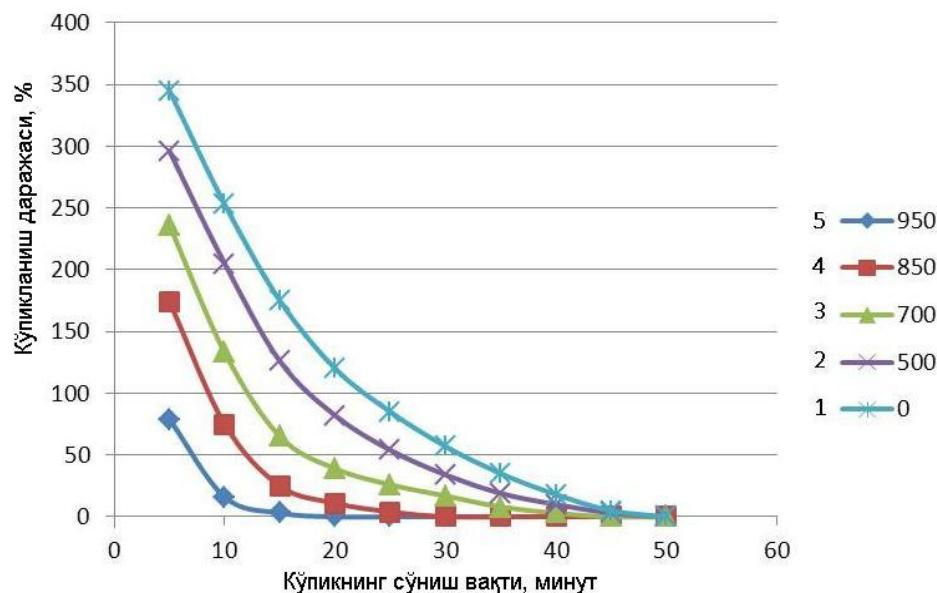
**1-расм. Кальций ва магний карбонатли чиқинига термик ишлов бериш ҳароратига боғлиқ ҳолда ЭФКни нейтраллаш жараёнида кўпикланиш даражасининг вақт давомида ўзгариши: 1 – кальций ва магний карбонатли чиқинига термик ишлов берилмаган; 2 – 500°C; 3 – 700°C; 4 – 850°C; 5 – 950°C.**
